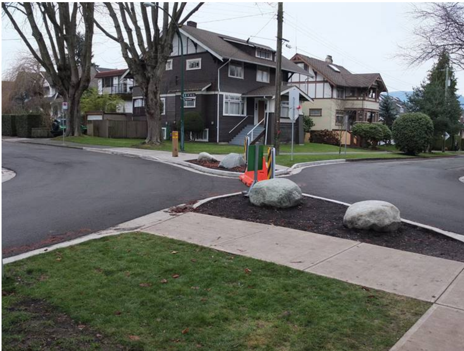
Приказ на реконструкција на постојна вообичаена крстосница со примена на дијагонален насочувач кај кој е оставена можноста за минување во итни случаи
