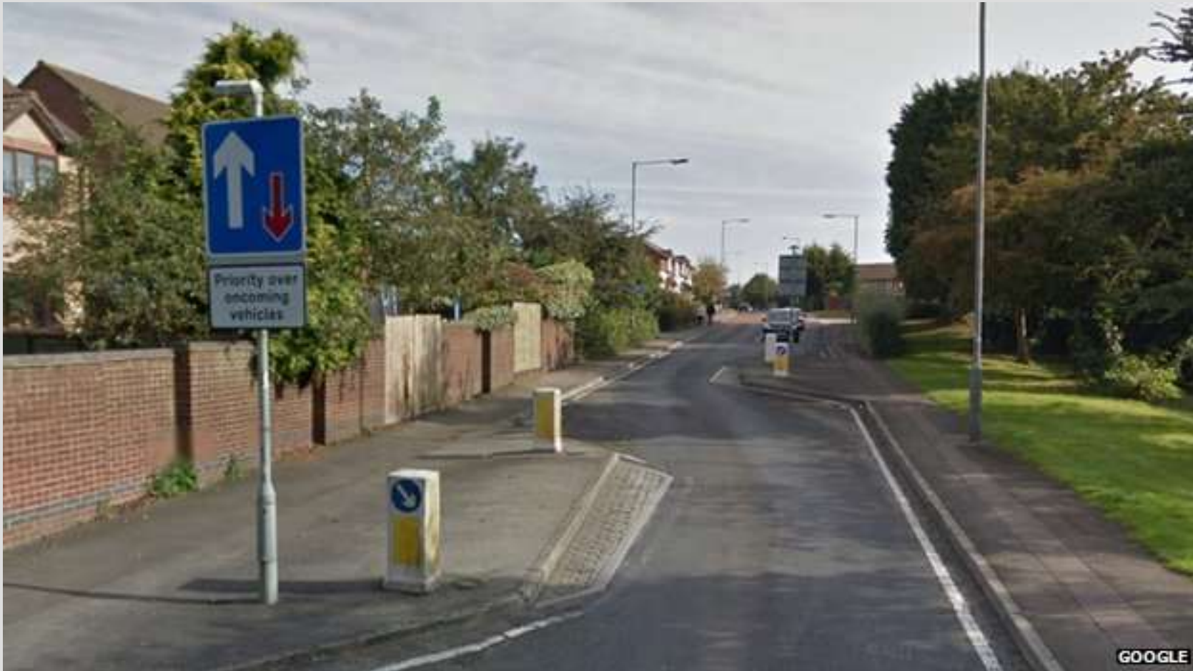
Сл. 8 Приказ на сообраќајница со шикана која заради своите елементи на градежно обликување оневозможува движење со зголемена брзина со дополнителна мерка на утврдување на предност при движењето на возилата во еден од правците
