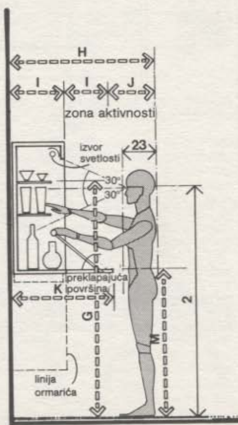
BAR MONTIRAN NA ZIDU/PRISTUP OD STRANE ŽENE
