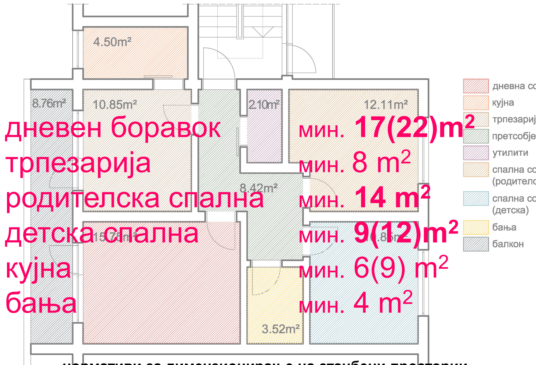
нормативи за димензионирање на станбени простории (Правилник за стандарди и нормативи за проектирање)
