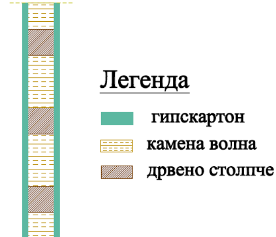
Дрвени столпчиња како дел од дрвена подконструкција во преграден сид
