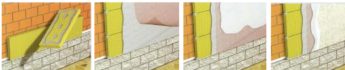
Сл. 34 Чекори на вградување на контактна фасада
